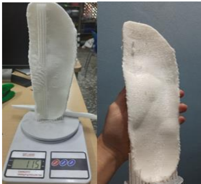
Figura 127. Retiro de soporte de impresión de la plantilla. Autoria propia.
