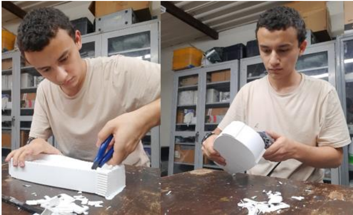
Figura 139. Refinamiento del molde. Autoria propia.
