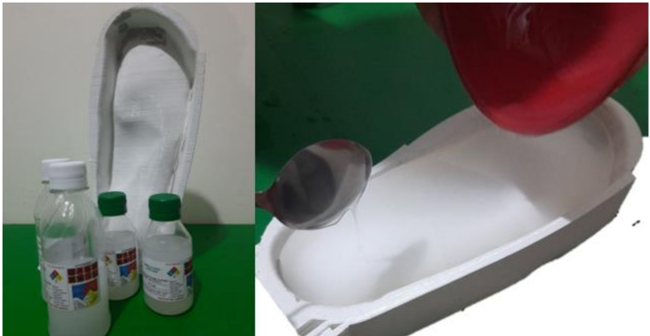
Figura 141. Vertimiento del Gel Ecoflex 20A. Autoria propia.
