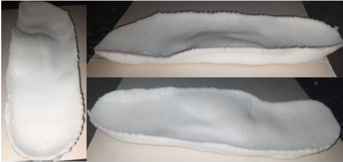
Figura 128. Prototipo de plantilla personalizada para pie plano impresa en filamento flexible. Autoria propia.
