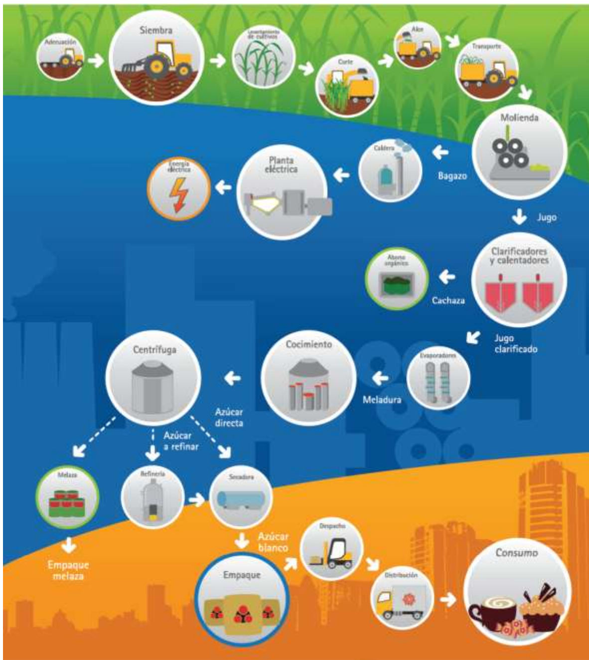
Figura 4. Proceso productivo de azúcar en Riopaila Castilla S.A. (Fuente: Informe de sostenibilidad, 2011)
