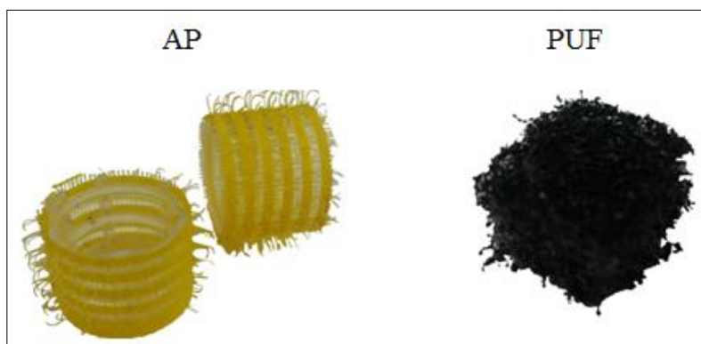
Figura 8. Materiales de soporte no comerciales utilizados en el estudio. Anillos plásticos (AP) y Espuma de poliuretano (PUF)
