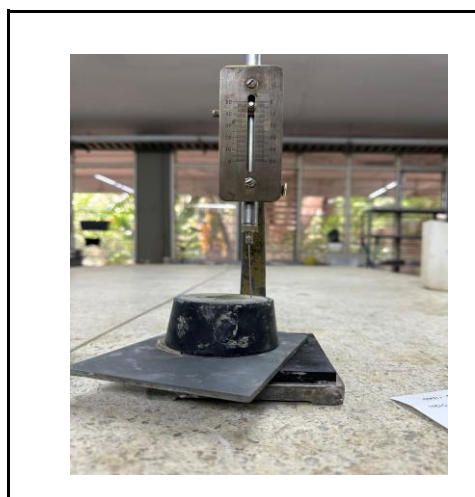
Figura 6. Montaje de ensayo de Vicat. (Fuente: Elaboración propia)
