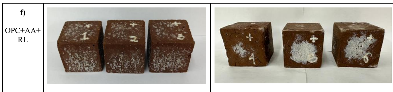
Figura 30. Apariencia de morteros con arena de vidrio expuestos en sulfato de magnesio durante 28 y 120 días. (Fuente: Elaboración propia)
