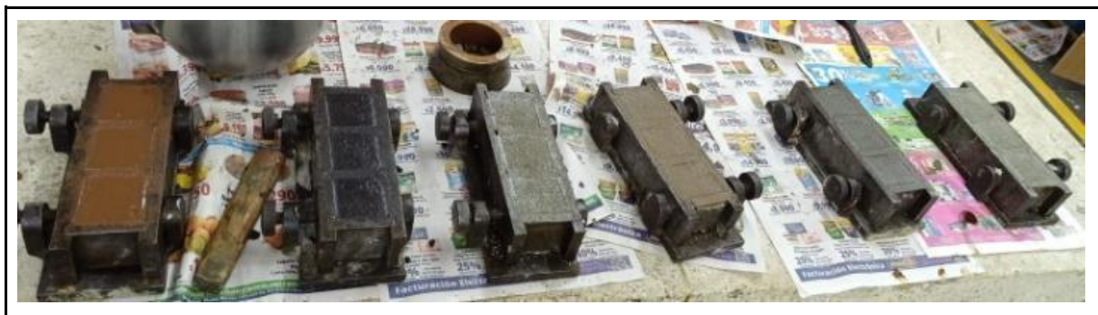
Figura 8. Morteros encofrados en moldes cúbicos (Fuente: Elaboración propia).
