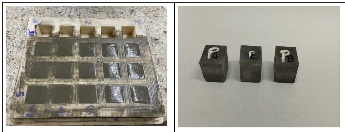
Figura 5. (izq) Pasta de cemento vaciada en molde y (der) cubos desencoformados. (Fuente: Elaboración propia)
