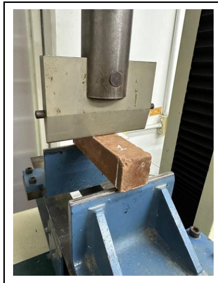
Figura 12. Ensayos de flexión en vigas. (Fuente: Elaboración propia)
