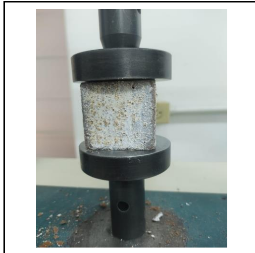
Figura 11. Montaje de ensayo para resistencia a la compresión de morteros. (Fuente: Elaboración propia)
