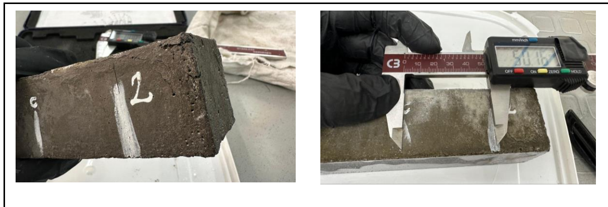
Figura 32. Muestra de expansión en vigas y toma de medidas. (Fuente: Elaboración propia)
