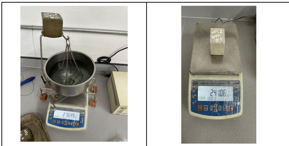
Figura 10. Montaje del ensayo densidad, porosidad y absorción de morteros. (Fuente: Elaboración propia)
