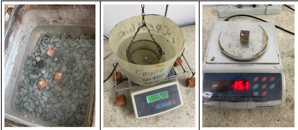
Figura 7. Montaje del ensayo densidad, porosidad y absorción de las pastas. (Fuente: Elaboración propia)
