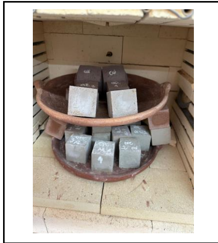
Figura 14. Probetas organizadas dentro del horno para ensayo térmico a 800°. (Fuente: Elaboración propia)
