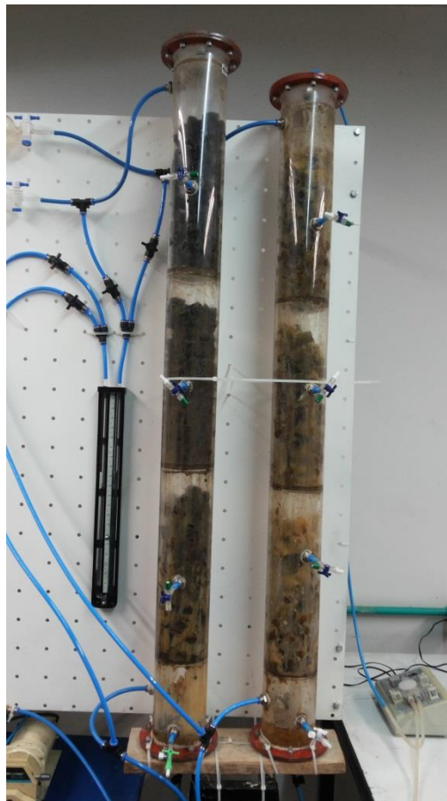
Figura 31. Sistema de biodegradación del aire contaminado.
