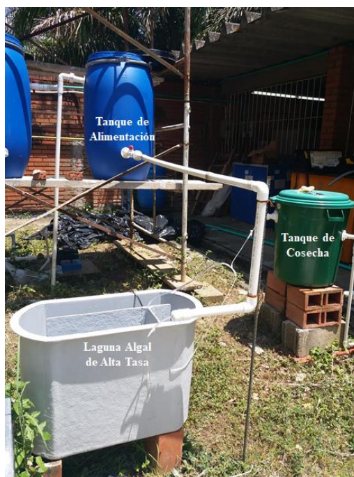
Figura 5. Sistema Laguna Algal de Alta Tasa
