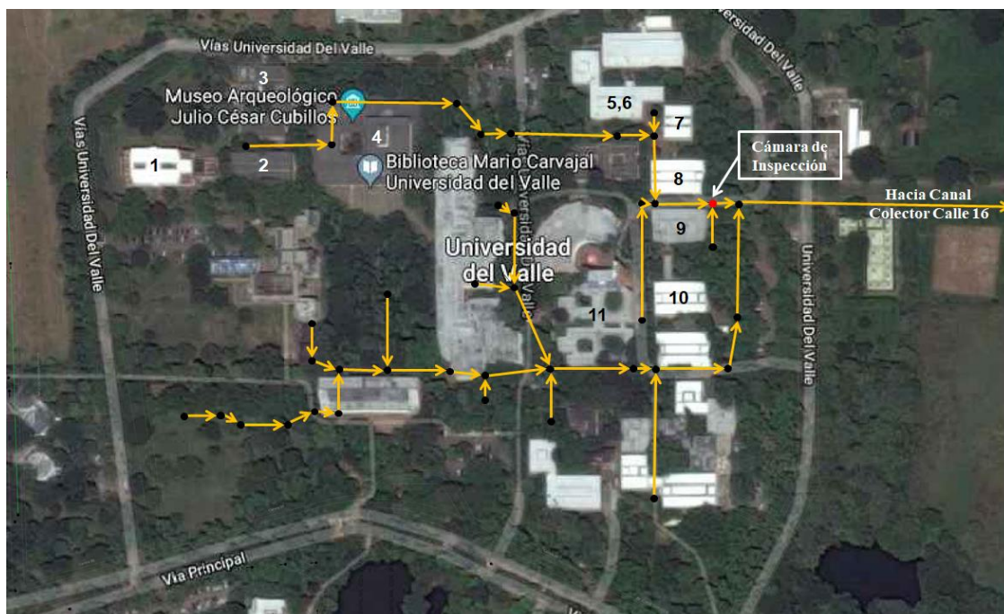
Figura 8. Esquema red de alcantarillado Universidad del Valle
