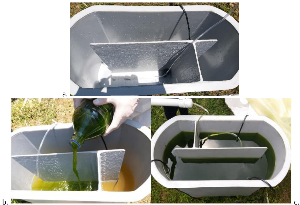
Figura 9. Proceso de arranque Laguna Algal de Alta Tasa. a. Laguna Algal de Alta Tasa Instalada, b. Adición del inoculo de Paracholrella Kessleri , c. Montaje final Laguna Algal de Alta Tasa
