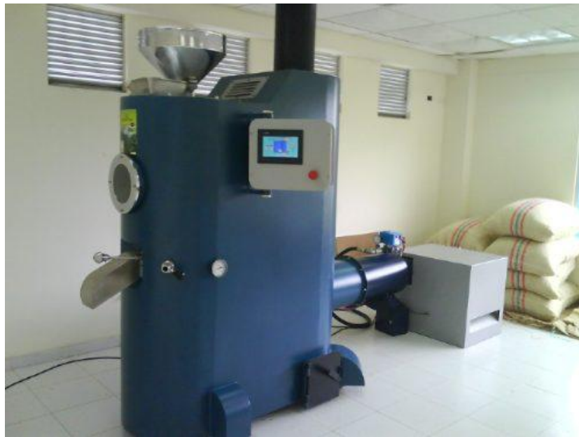
Figura 3. Torrefactora de café en lecho fluidizado con capacidad de producción de 1Kg/min. (Foto tomada de www.mercadolibre.com )
