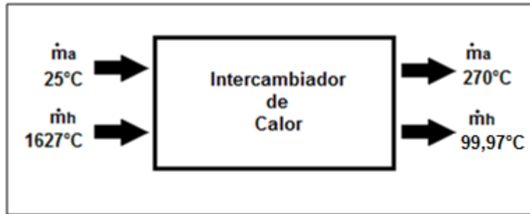
Figura 13. Entradas y salidas de los fluidos al intercambiador de calor.
