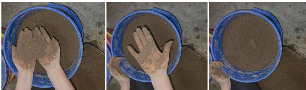
Ilustración 17. Prueba de humedad.
