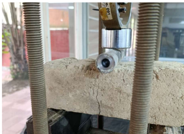
Ilustración 33. Falla de bloque B2
