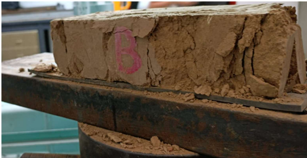
Ilustración 30. BTC con adición de teja (BT) después del ensayo.
