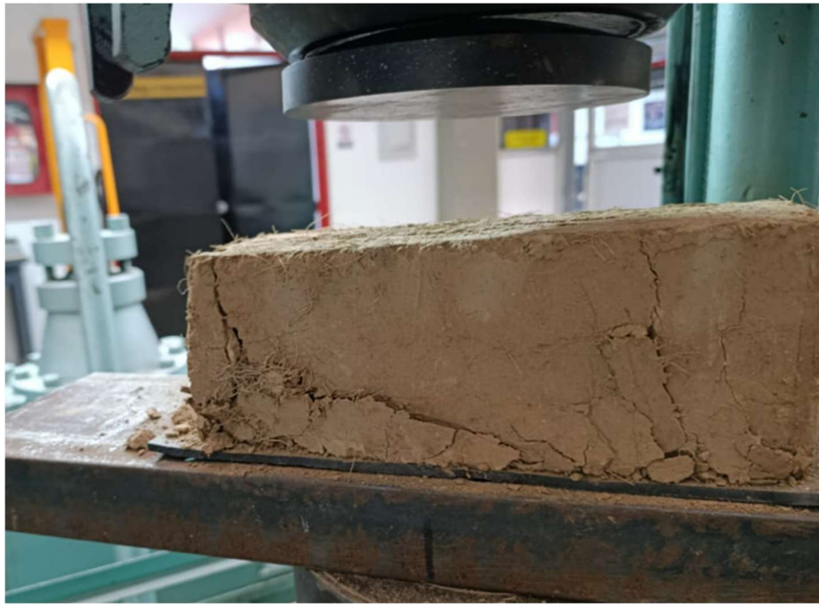
Ilustración 29. Bloque de fibra (BF6) después de ensayo.
