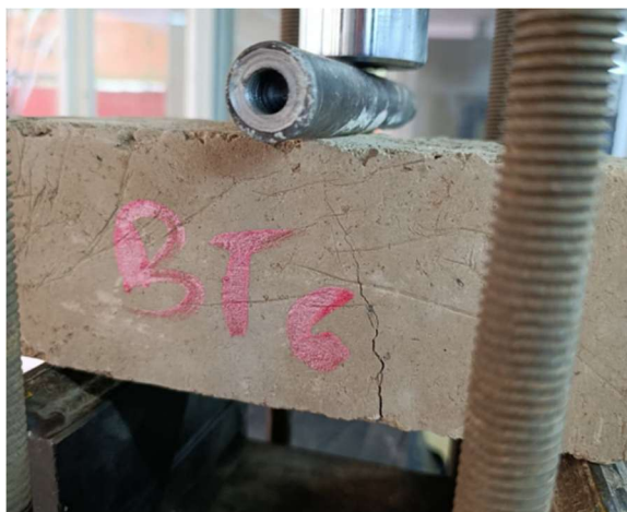
Ilustración 34. Falla de bloque BT6
