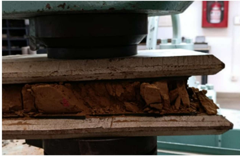
Ilustración 28. Adobe (muestra original) después del ensayo.
