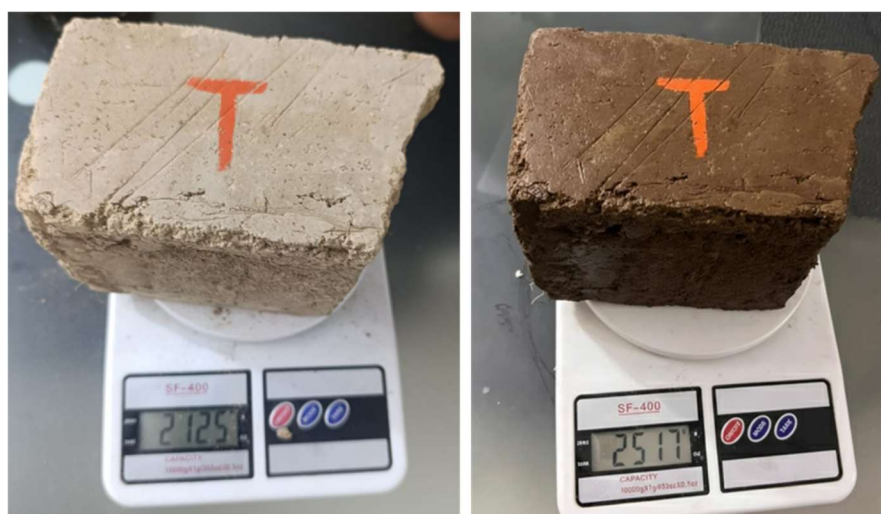
Ilustración 27. Prueba de absorción de agua. NTC 4205
