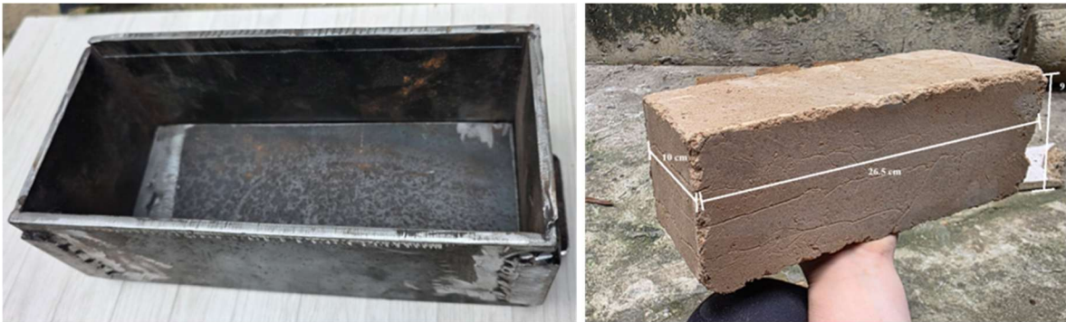
Ilustración 21. Molde y medidas nominales de las unidades de mampostería (BTC)
