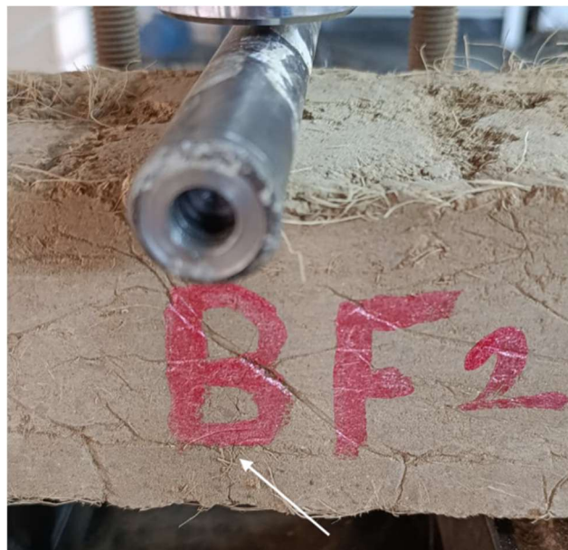
Ilustración 35. Falla de bloque BF2
