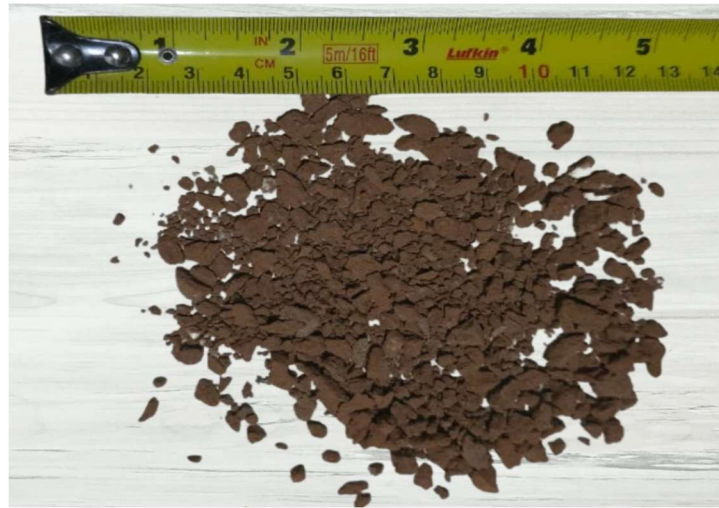
Ilustración 19. Tamaño nominal de la teja triturada
