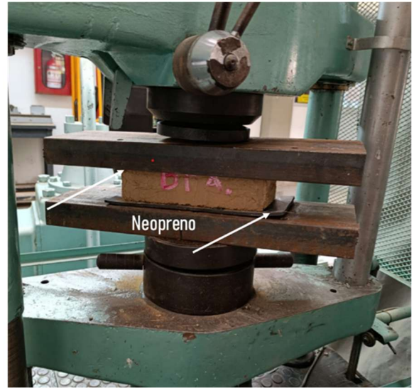
Ilustración 23. Ensayo de compresión.
