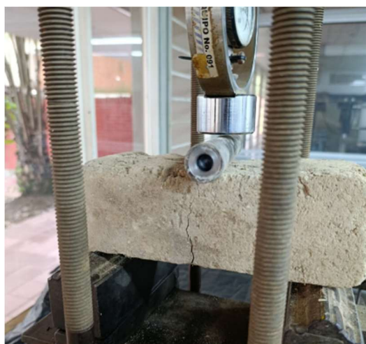
Ilustración 32. Ensayo de flexión. B2
