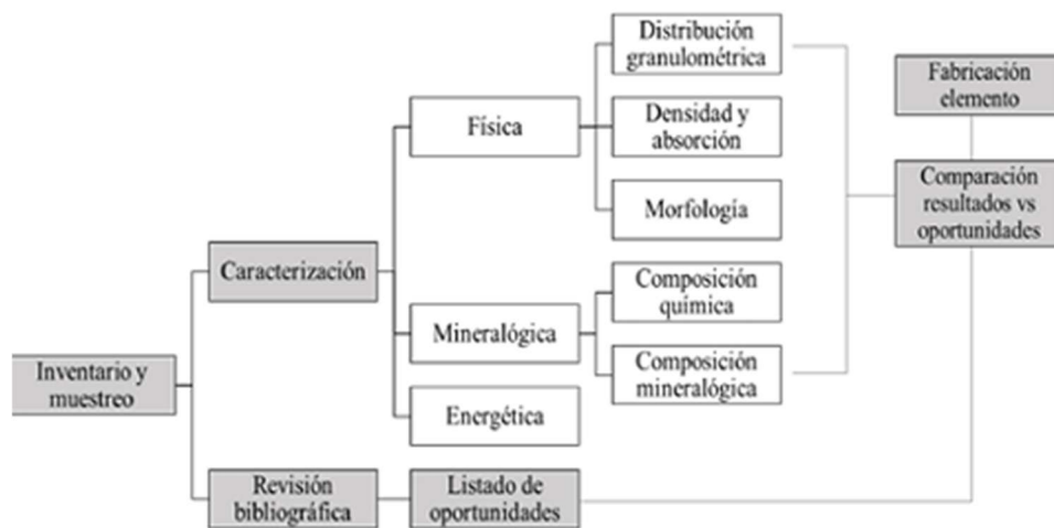
Ilustración 6. Esquema de la metodología experimental empleada [9]
