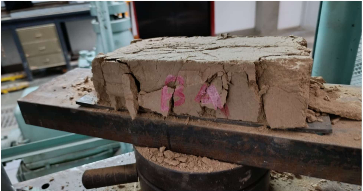
Ilustración 31. BTC con presión de compactación después del ensayo.
