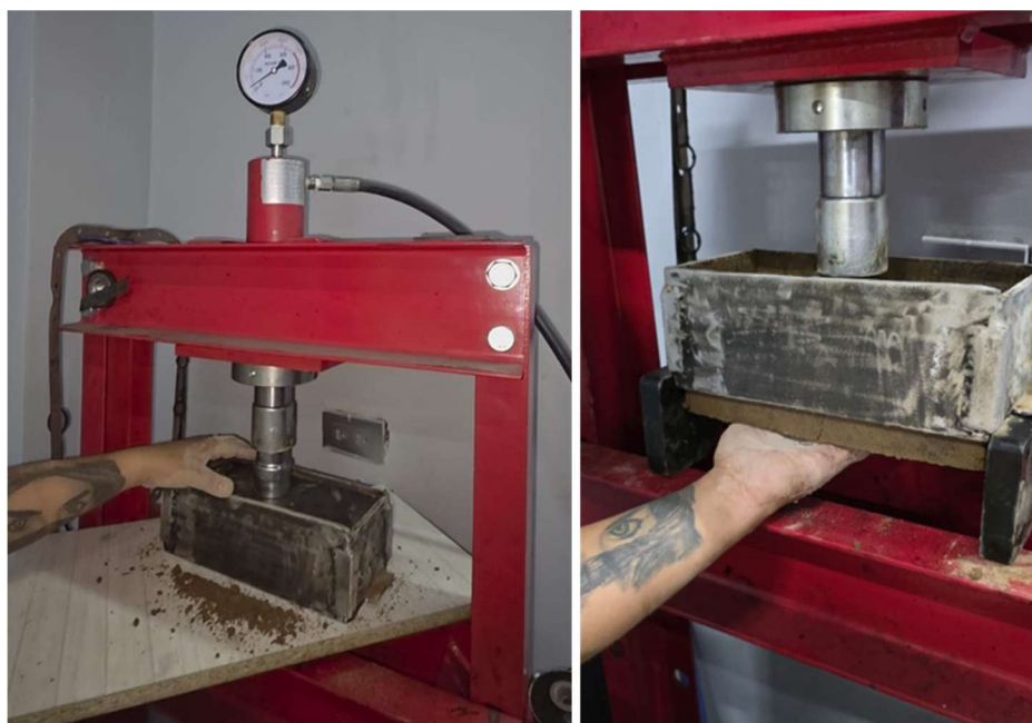
Ilustración 18. Elaboración BTC sin aditivos con presión de compactación de 6.5 kg/cm 2
