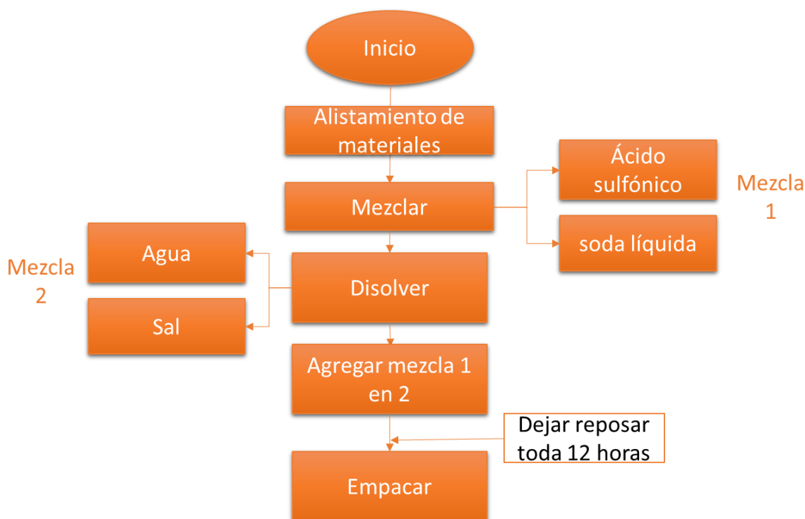
Gráfica 14 Proceso de elaboración – Jabón multiusos
