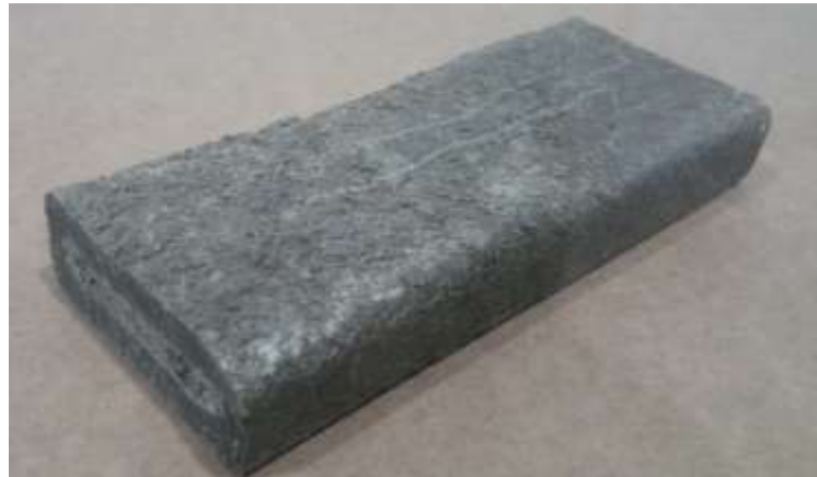
Figura 2 – Prototipo #1 de madera a base de materiales plásticos.
