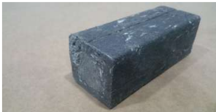
Figura 3 – Prototipo #2 de madera a base de materiales plásticos.
