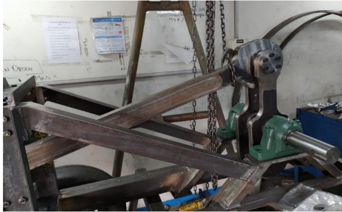
Figura 24. Montaje del mecanismo de compactación
