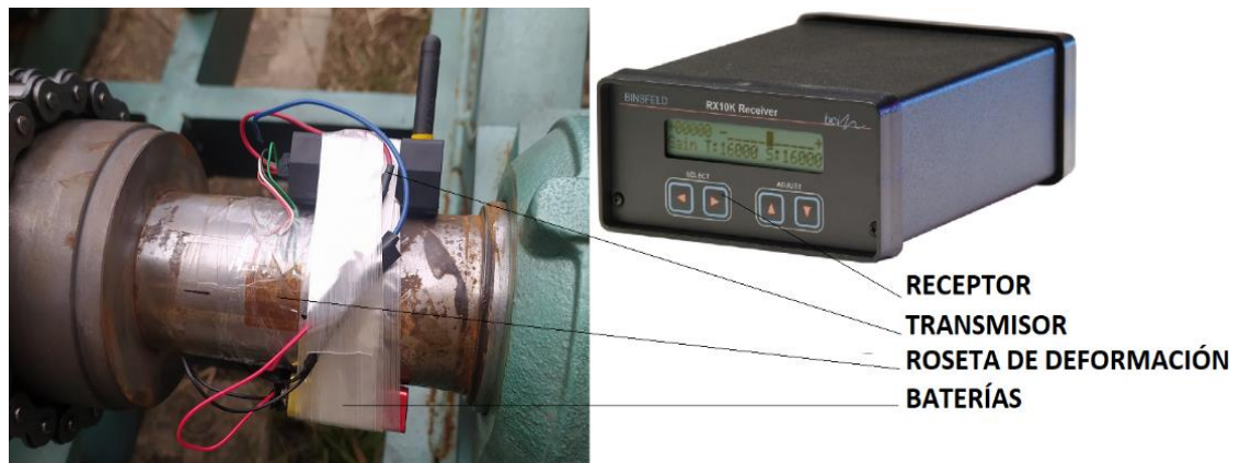
Figura 27. Sistema telemétrico para adquisición de torque
