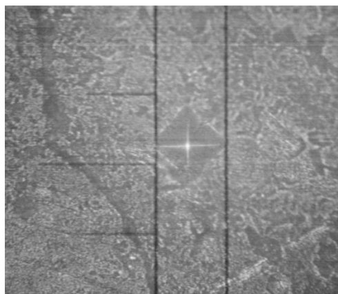
Fig. 4.16. Huella de indentación dejada por el microdurómetro después de realizado el ensayo.
