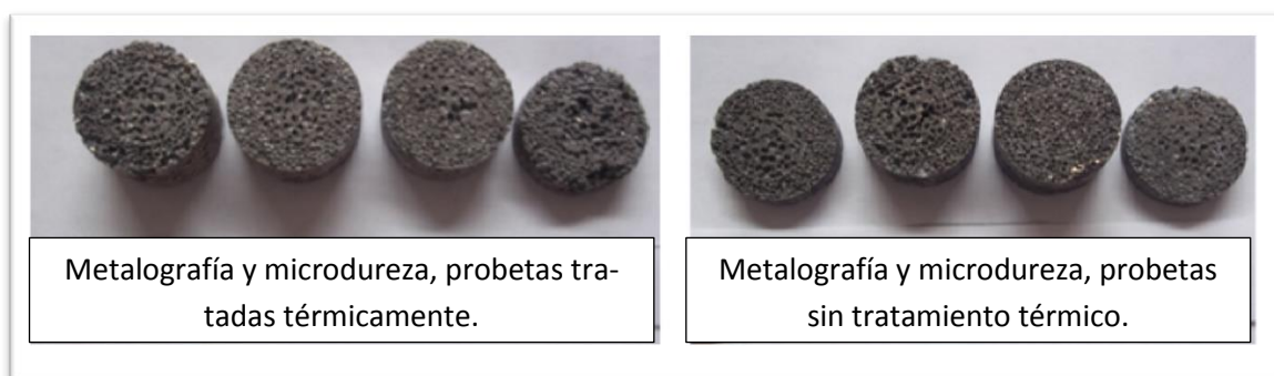
Fig.4.5. Probetas preparadas para análisis metalográfico con y sin tratamiento térmico.
