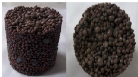
Fig. 2.9 Preforma de sal sinterizada, muestra el contacto íntimo entre las esferas de sal.
