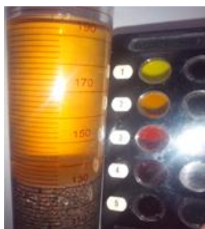
Figura 36. Ensayo de Materia orgánica para la arena
