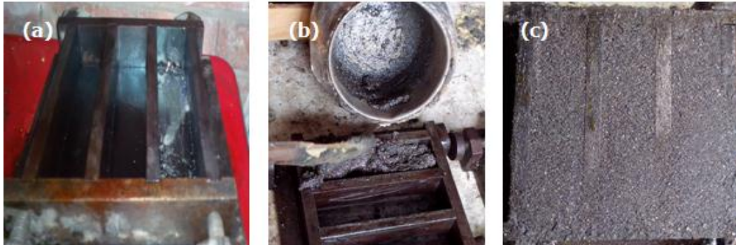
Figura 28. (a) Calentamiento del molde, (b) vaciado de la mezcla, (c) mortero enfriando a Temperatura Ambiente.
