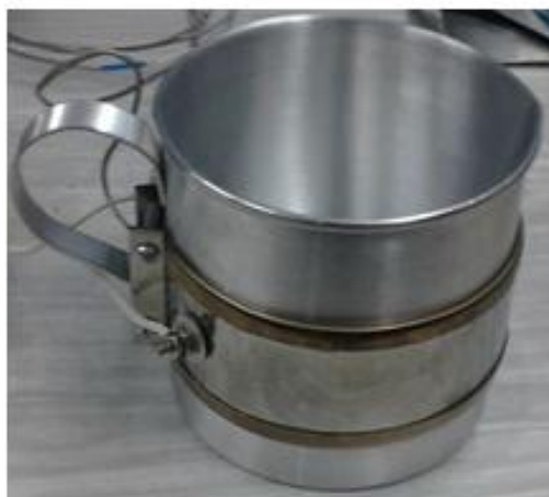
Figura 23. Recipiente con resistencia de 600 w
