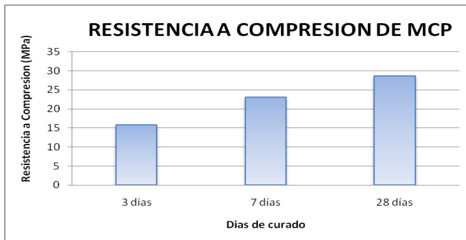
Figura 38. Comportamiento de la resistencia a la compresión de MCP
