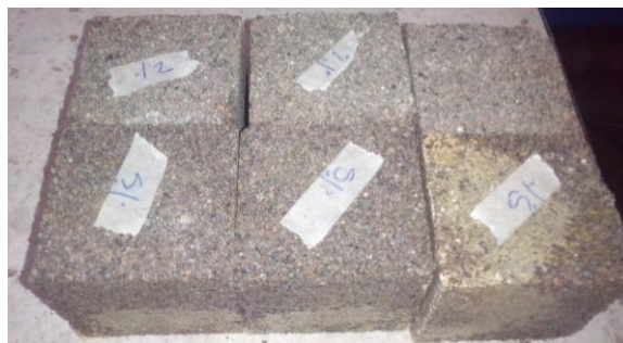
Figura 40. Morteros de azufre con 2% y 5% de aceite vegetal
