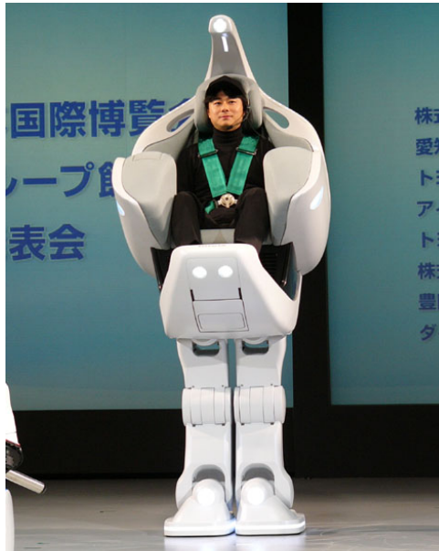
Imagen 25. iFoot, Robot caminante desarrollado por Toyota, puede operar accionado por el movimiento de la persona que en el se incorpora.
