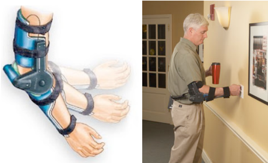
Imagen 40. Myomo, brazo robótico desarrollado por el M.I.T. Robot Potencializador
