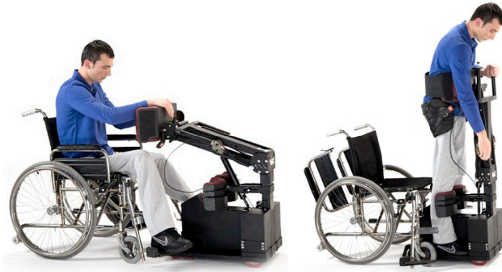
Imagen 44. TekRMD (Tek Robotic Mobilization Device), desarrollado por AMS Mekatronik. Robot Asistencial.
