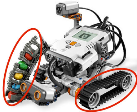
Imagen 9. Servomotores del robot, Lego MindStorm le permiten lanzar las bolas de colores y desplazarse.
