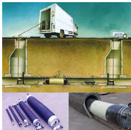
Imagen 35. Proceso de reparación de tuberías sin necesidad de obra. Ejemplo de un robot profesional de mantenimiento.
