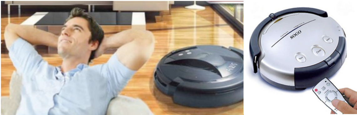
Imagen 26. Robot aspiradora, puede operar de manera autónoma o por control remoto.
