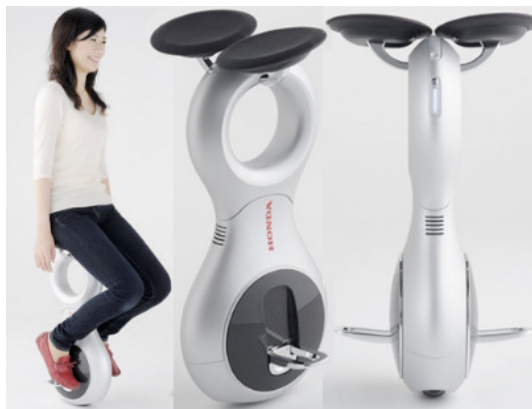
Imagen 47. U-3x de Honda puede desplazarse en cualquier dirección a una velocidad de hasta 6km/h.
