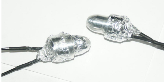
Figura. 3.3.1: Encapsulado construido para proteger los termistores.
