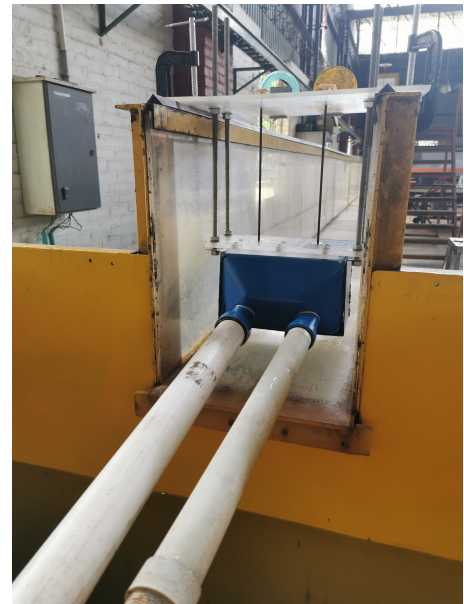
(b) Tubo de PVC acoplados en la descarga.
