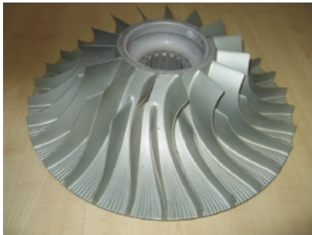
(a) Rotor de un compresor centrífugo de un motor de una turbo hélice
