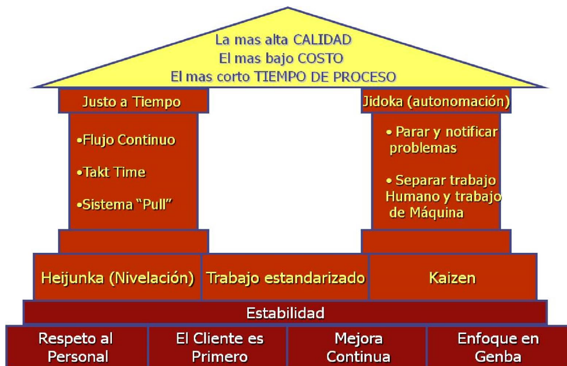
Figura 5. Pilares del TPS. Fuente: Institucional
