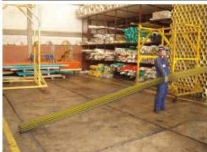
Imagen No.2: Manejo de tubería - Incorrecta.
