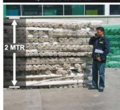
Imagen No.7: Altura máxima de apilamiento de tuberías.
