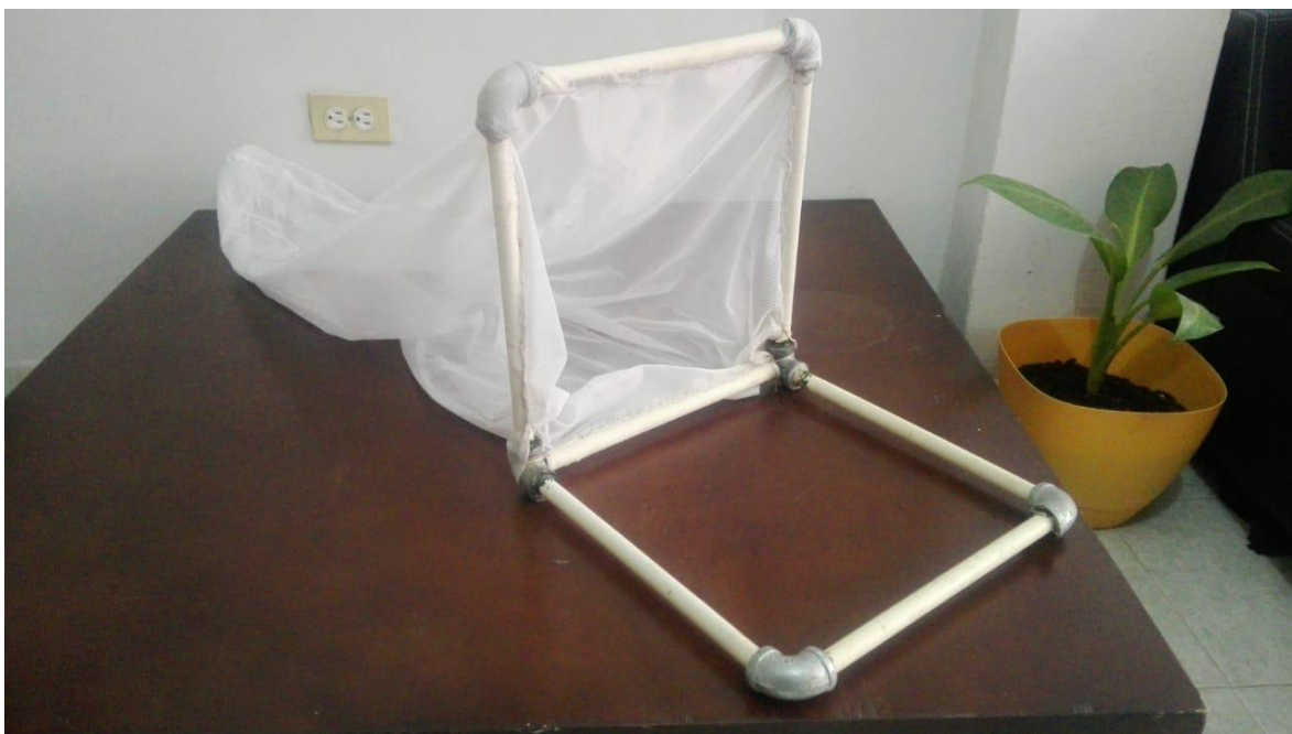
Ilustración 1. Red Surber construida.
