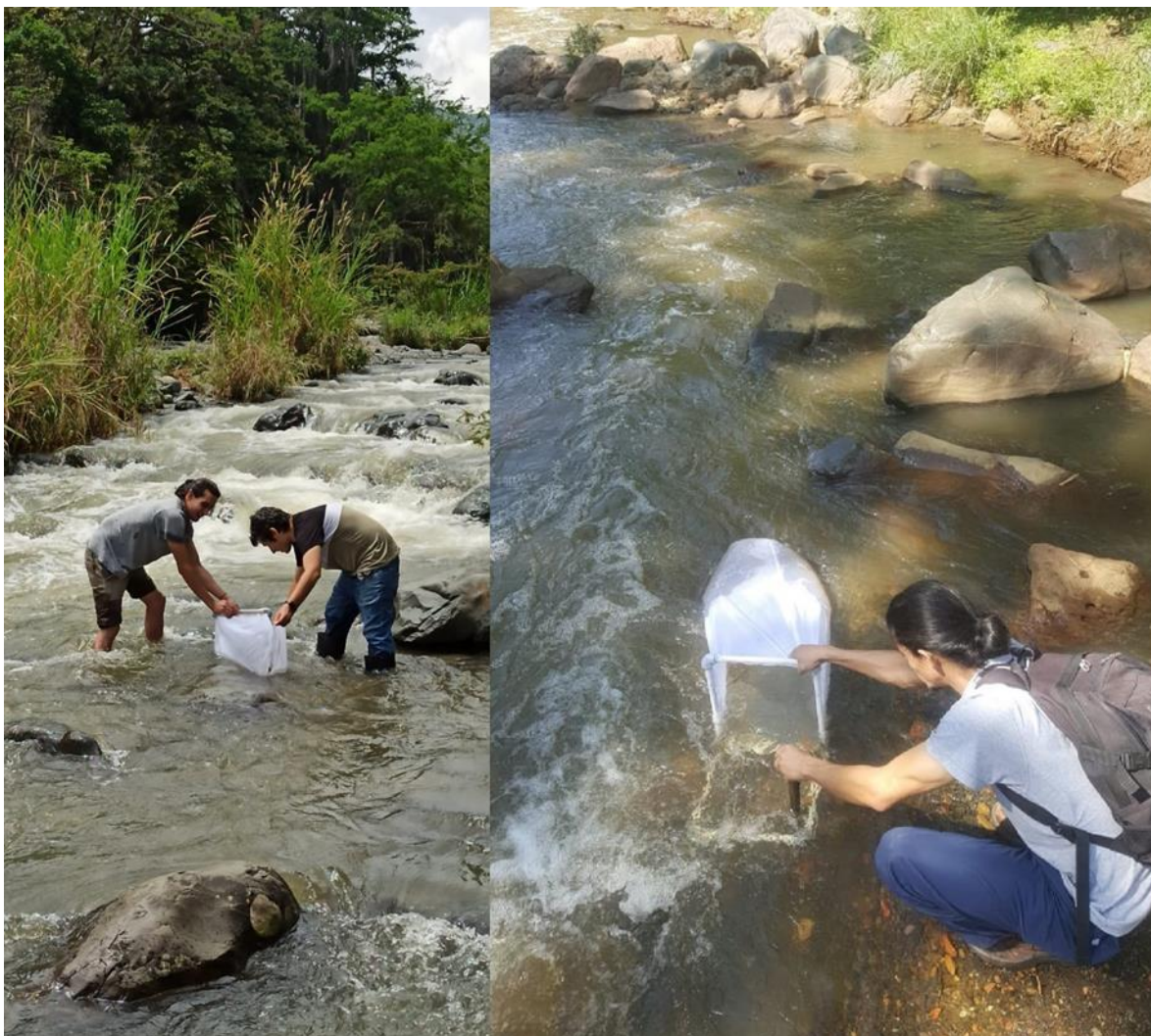
Ilustración 3. Modo de empleo de la red Surber.
