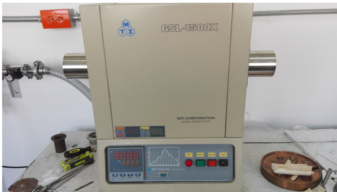
Figura 11: Horno tubular usado. Su temperatura máxima de operación es 1500^{\circ}C con \pm 1^{\circ}C de precisión.
