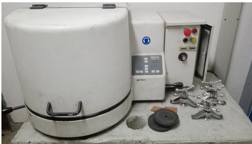
Figura 10: Molino Planetario usado. Pulverisette 5.
