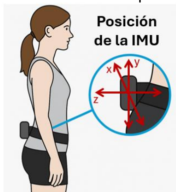
Ilustración 13. Ubicación de la IMU en el sistema optimizado
