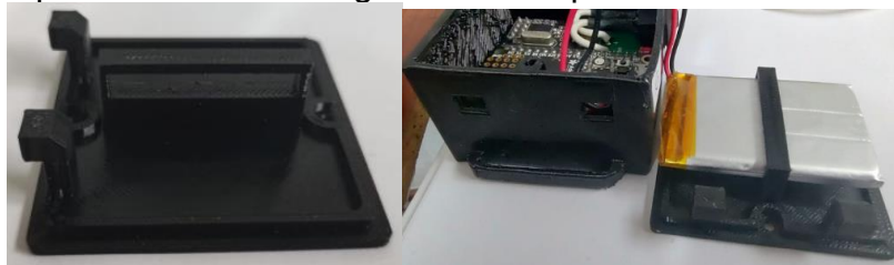
Ilustración 18. Soporte de batería integrado en la tapa del módulo
