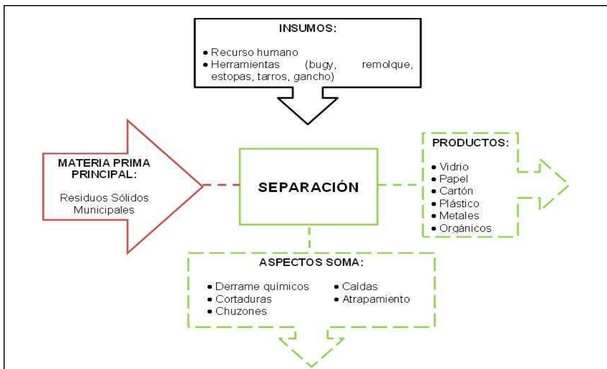
Figura 19. Diagrama funcional de bloques del proceso de separación de la E.S.P de Aseo.
