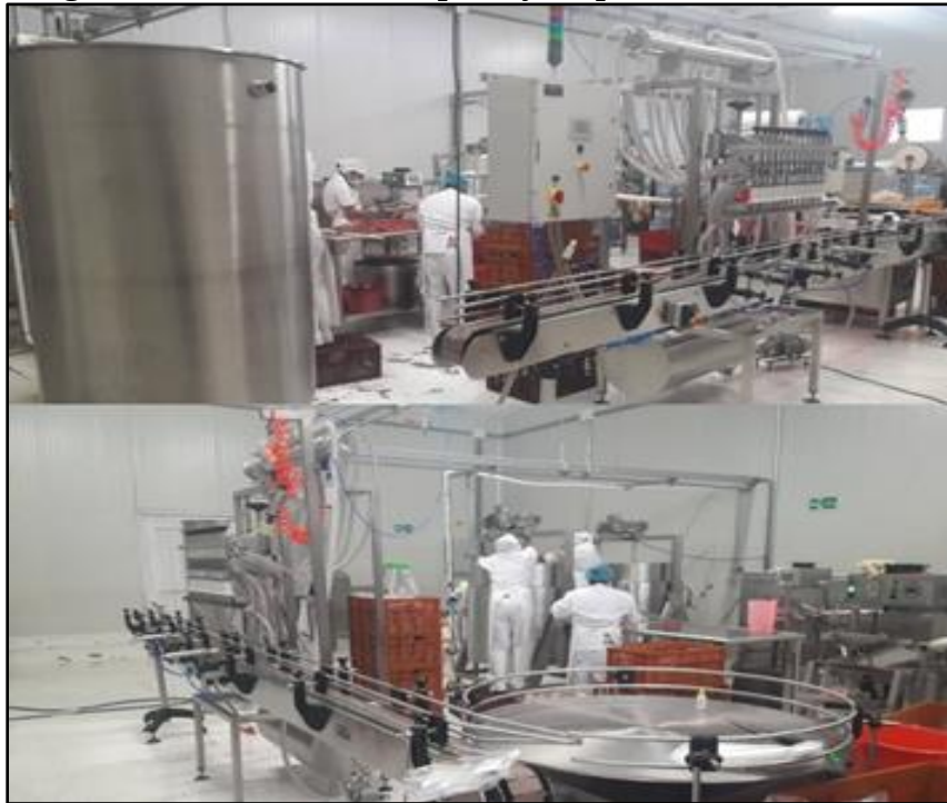
Imagen 10 Embotellado, tapado y etiquetado
