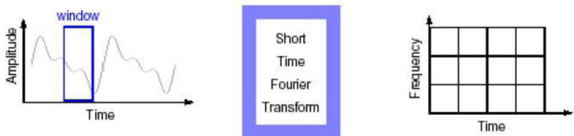
Figura 4: Diagrama esquemático de cómo actúa la TFV en una señal (Extraído de Mathworks,1997)
