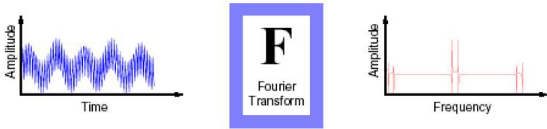
Figura 3: Diagrama esquemático de cómo actúa la transformada de Fourier en una señal (Extraído de Mathworks, 1997)
