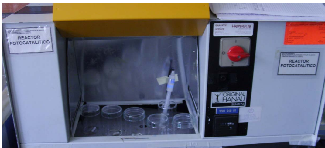
Figura 1. Simulador solar SunTest y reactores batch empleados en los ensayos exploratorios
