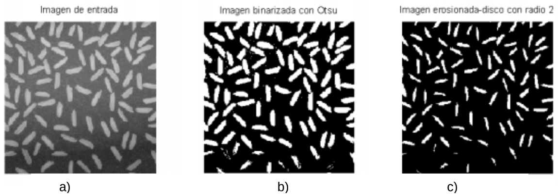
Figura 4:a) Imagen original, b) Imagen segmentada, c) Imagen erosionada con elemento estructurante tipo disco de radio 2
