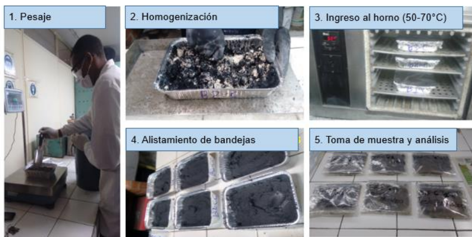
Figura 10. Procedimiento para la estabilización térmica
