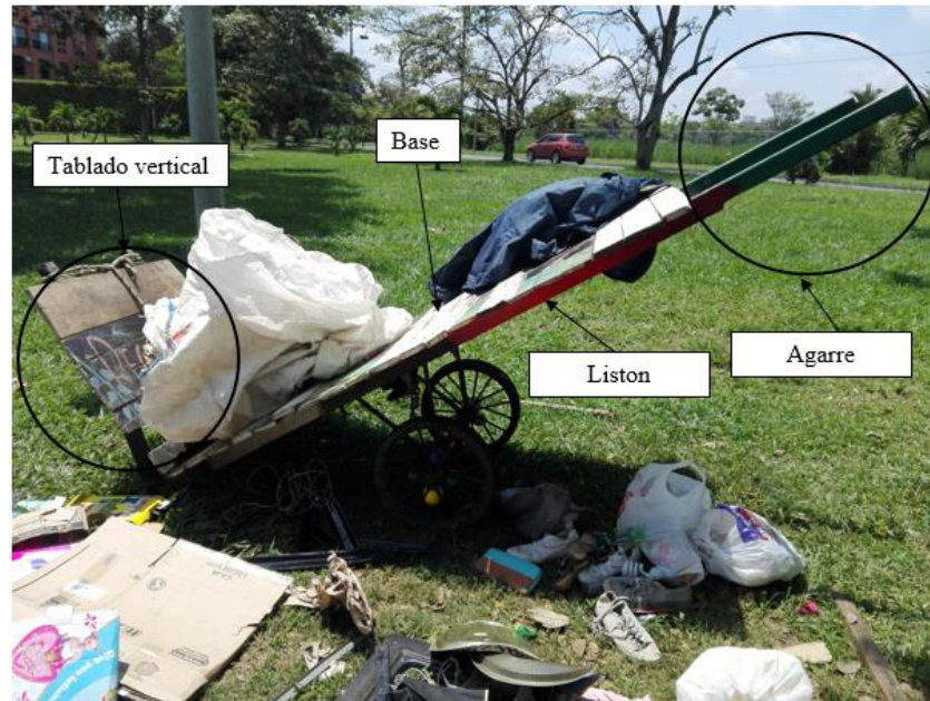
Figura 29. Partes de una carreta
